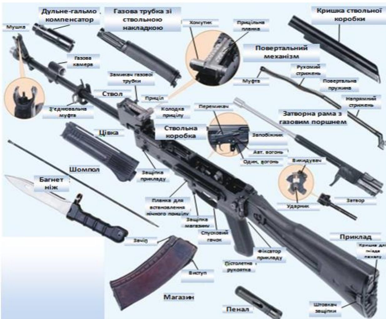
Рис. 45 – Будова 5,45-мм автомата Калашникова
