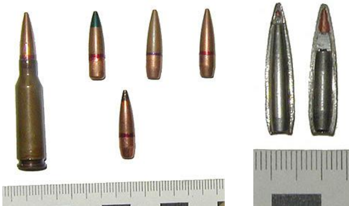
Рис. 48 – Загальна будова 5,45-мм автоматного патрона (5,45×39), а також розріз кулі до нього
