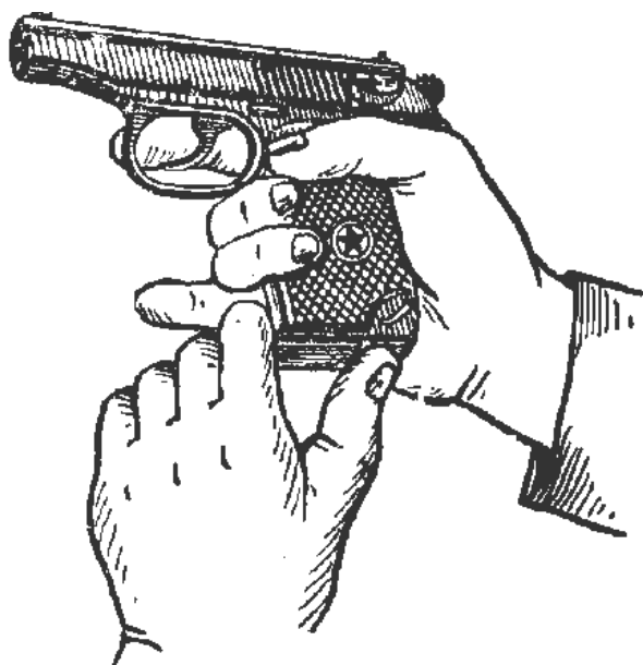
Рис. 55 – Витягування магазина з основи рукоятки
