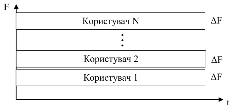
Рис. 2.12. Принцип дії FDMA
