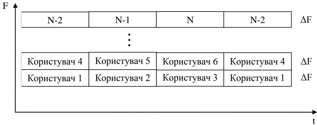
Рис. 2.13. Принцип дії TDMA
