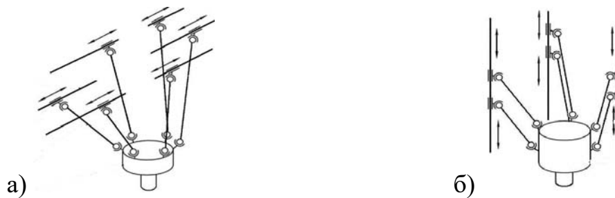
Рисунок 5.12 – Схеми механізмів с постійною довжиною штанг: а – гексаглайд; б – лінапод; 1 – платформа; 2 – штанга; 3 – каретка; 4 – напрямна
