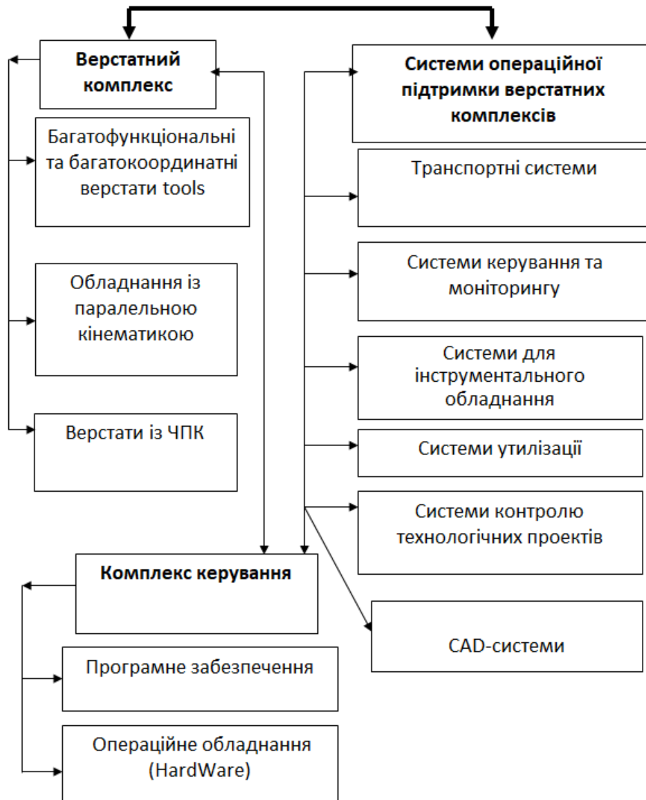
Рисунок 5.3 – Структурні зв’язки сучасного верстатного комплексу
