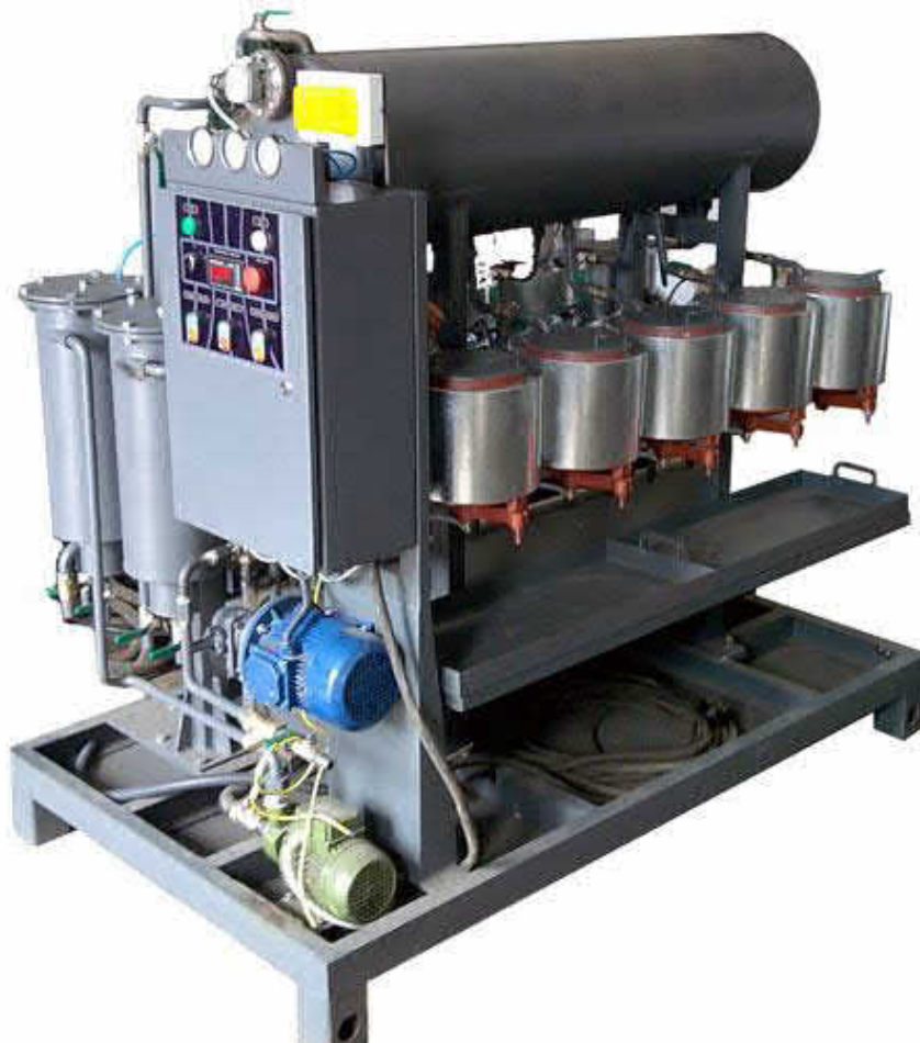
Рис. 3.10 – Установа для одержання водо-паливних емульсій і біодизельного палива [80]
