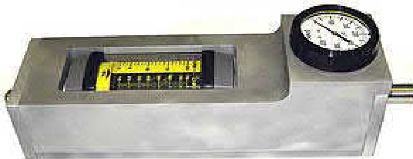
Рис. 3.17 – Модель гомогенізатора TRGA з датчиком тиску й витратоміром
