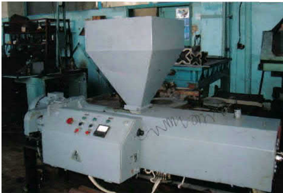
Рис. 3.7 – Загальний вигляд установки для виробництва біодизельного палива
