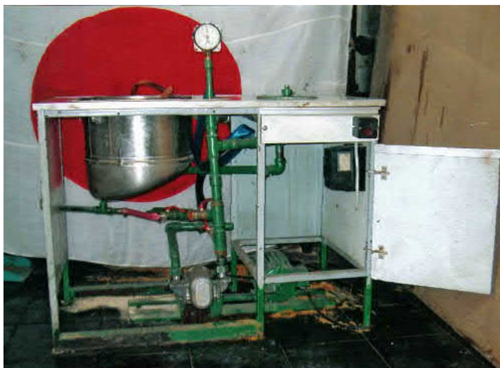
Рис. 3.8 – Робочий елемент установки для виробництва біодизельного палива
