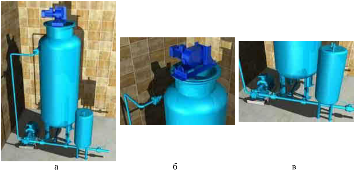
а – вбудований занурений нагрівник кавітації (модифікатор); б – додаткова ємкість із олійним насосом та обв'язкою; в – шнекова мішалка
