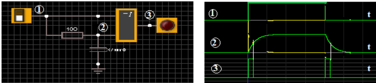
Рисунок 5.16 – Схема виділення перепаду з «0» в «1», з «1» в «0» та часові діаграми її роботи
