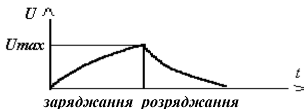
Рисунок 1.7 – Перехідний процес під час заряджання–розряджання конденсатора
