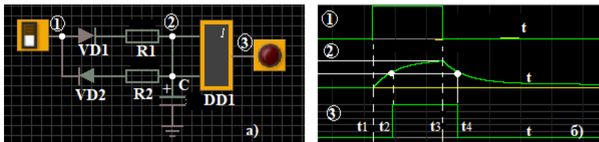
Рисунок 5.31 – Схема затримки сигналу на основі логічних елементів і RC-кіл
