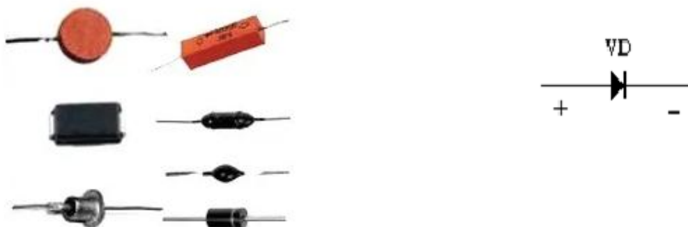
Рисунок 2.3 – Зовнішній вигляд і умовне позначення діода
