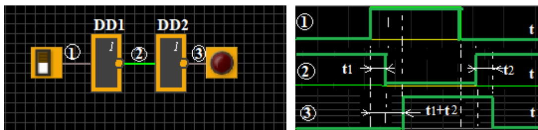
Рисунок 5.30 – Схема елемента затримки
