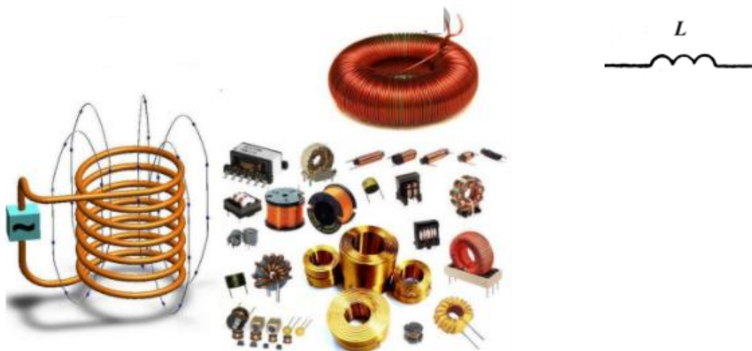
Рисунок 1.8 – Зовнішній вигляд і умовне позначення індуктивності
