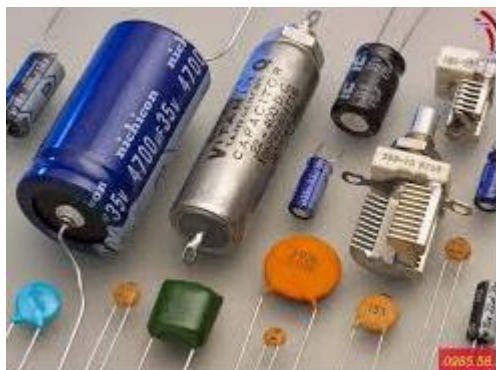
Рисунок 1.6 – Зовнішній вигляд і умовне позначення конденсатора
