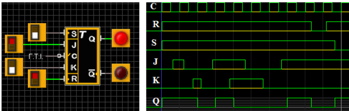
Рисунок 4.36 – Універсальний JK- тригер
