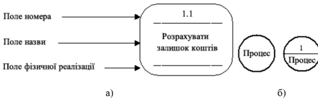
Рисунок 3.21 – Процес: а) нотація процесу за Gane and Sarson; б) Нотація процесу за Yourdon and Coad
