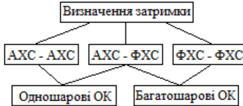
Рис. 3.11. Варіанти визначення часової затримки сигналу, що розповсюджується в акустичному тракті ультразвукового товщиноміра
