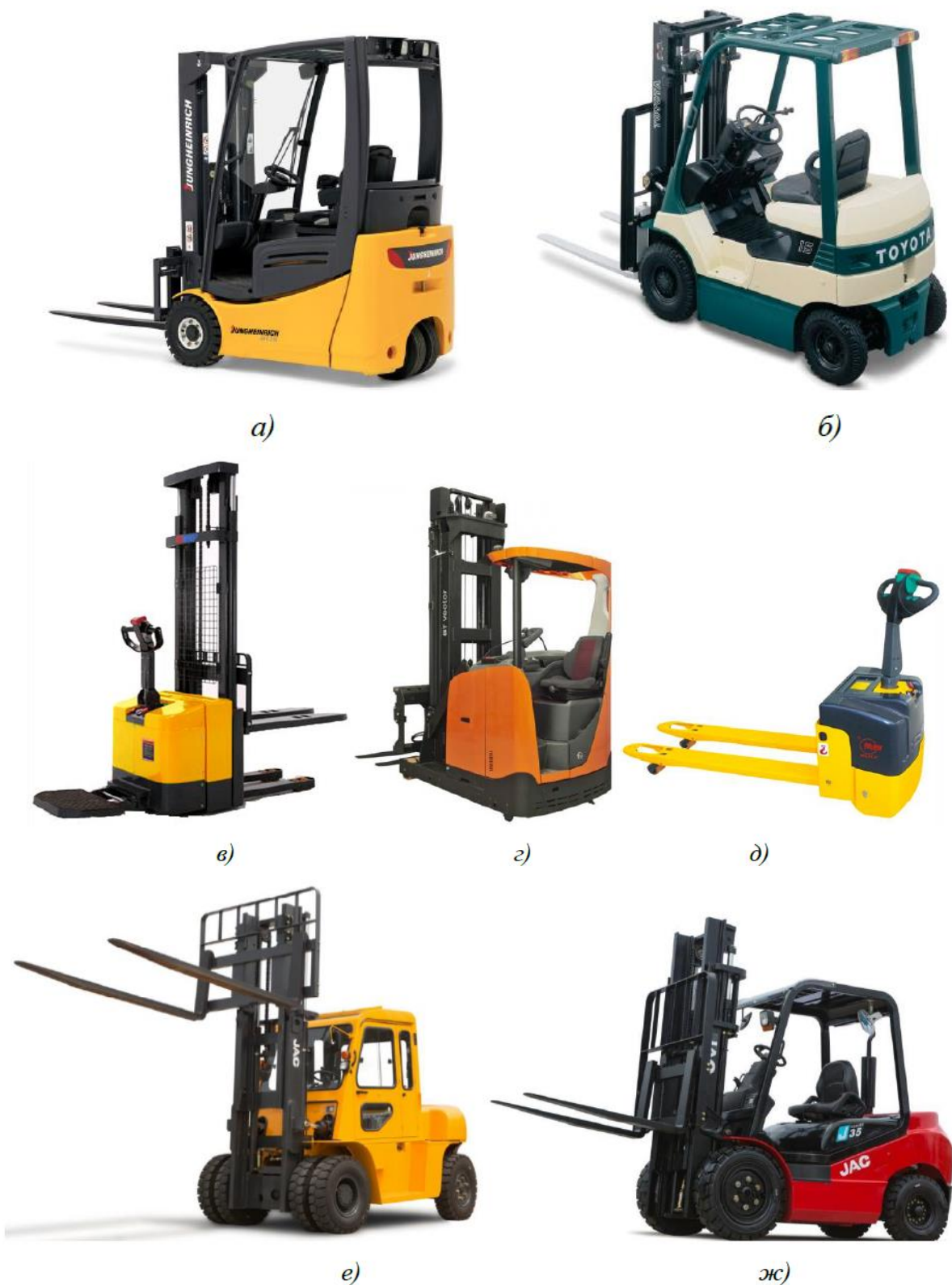
Рисунок 3.13 – Напольні вилочні навантажувачі: а) та б) електронавантажувачі; в) та г) електроштабелери; д) електровізок; е) та ж) автонавантажувачі
