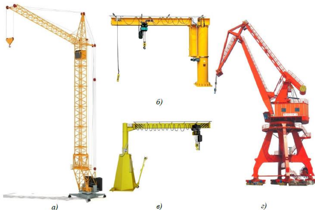
Рисунок 3.6 – Стрілові крани: а) баштовий; б) консольний стаціонарний; в) консольний пересувний; г) порталний
