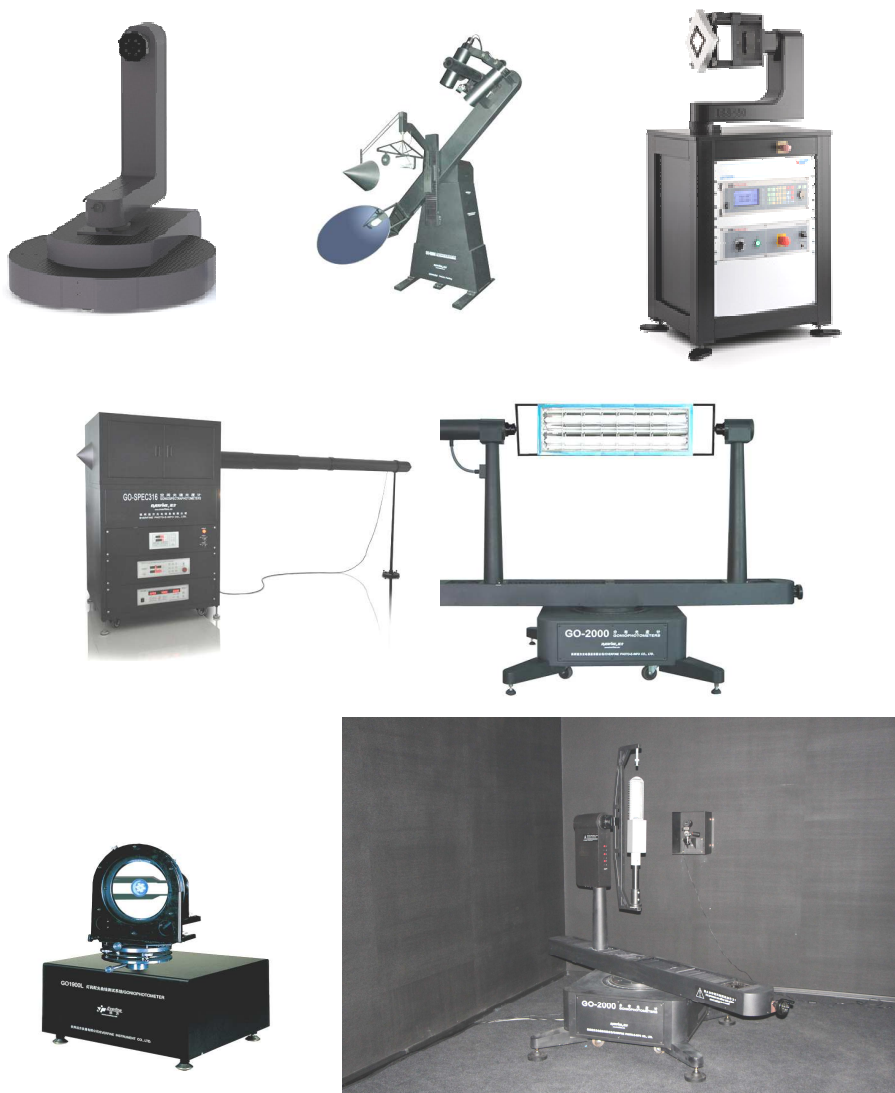
Рис. 10.12 – Конструкції сучасних гоніофотометрів для вимірювання зразків світлотехнічних приладів з розмірами до 2 \times 2 \text{ м}^2 в геометрії вимірювання СІЕ В- \beta або СІЕ С- \gamma у відповідності з міжнародними стандартами
