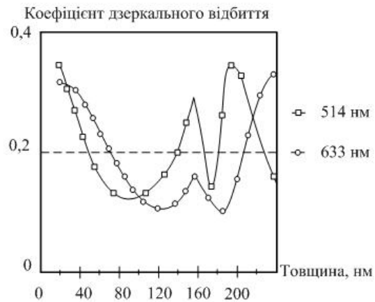
Рис. 2.11 – Розрахункові залежності від товщини спектрального коефіцієнта відбиття за двох значень довжини хвилі випромінювання, що падає
