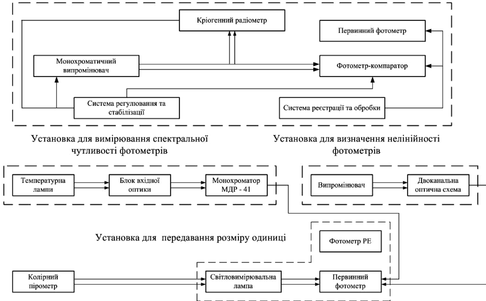
Рис 9.4 – Структурна схема еталона одиниці сили світла
