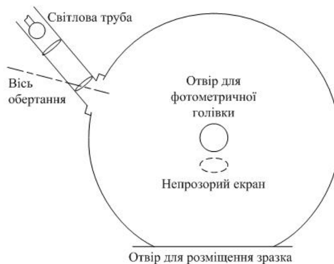
Рис. 6.9 – Оптична схема другого методу Тейлора
