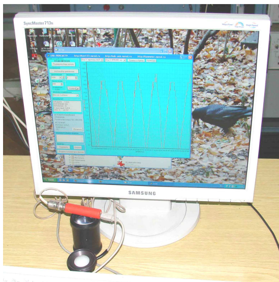
Рис. 4.20 – Зовнішній вигляд приладу „Тензор-71” у комплекті з насадкою для вимірювання яскравості фотометра цифрового ТЕС 093
