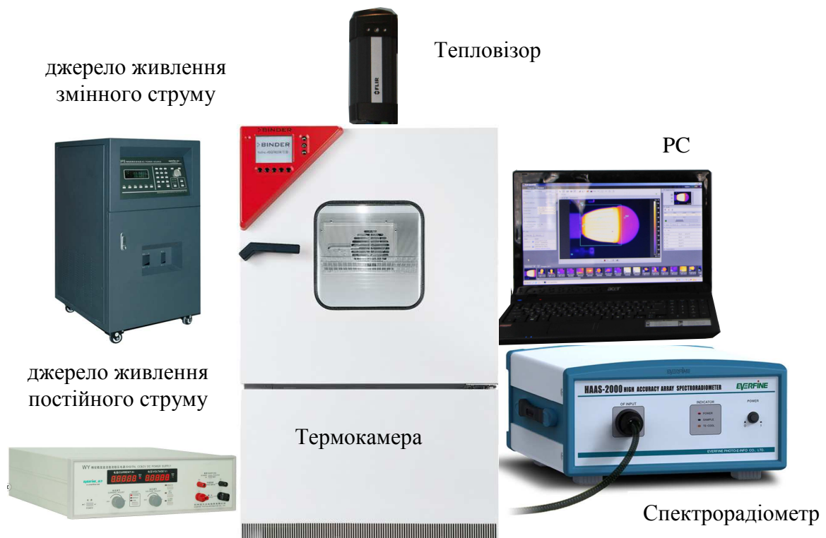
Рис. 10.20 –Експериментальний комплекс для проведення температурних досліджень світлотехнічних приладів
