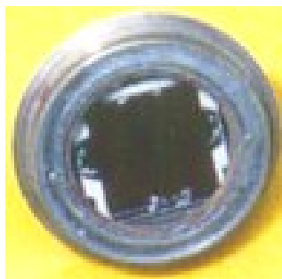
Рис. 4.6 - Зовнішній вигляд фотодіода на основі фосфiду галлiю для реєстрацiї УФ випромiнення
