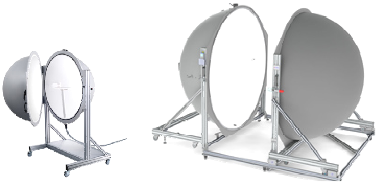
Рис. 10.7 – Фотометричні сфери діаметром 1м та 2м.
