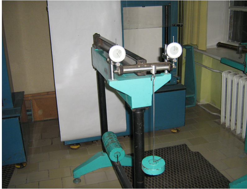
Рисунок 2.5 – Установка для визначення положення центра згину швелера
