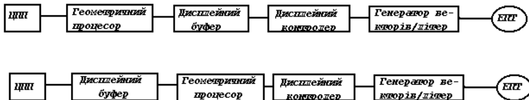
Рис.5.4. Концептуальні блок-схеми векторних дисплеїв з регенерацією.
