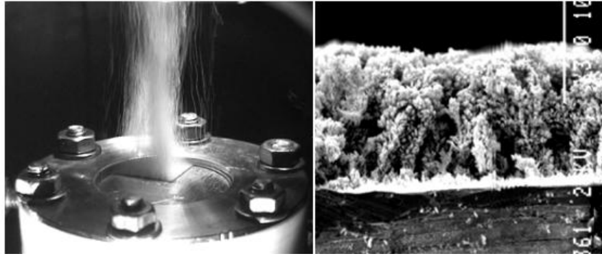
Рисунок 1.18 – Кипіння на мідній пластині за q = \text{const} з нанопокриттям (добре видно інтенсивне пароутворення) і гладкій поверхні (кипіння немає), та фото нанопокриття
