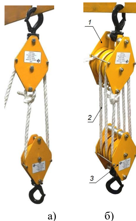
Рисунок 1.4 – Поліспаст монтажний одно роликовий (а) та багатороликовий (б): 1 – нерухомий блок, 2 – канат, 3 – рухомий блок
