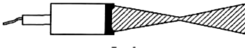
Рис.3.4. Фокусовані датчики з ультразвуковими акустичними лінзами
