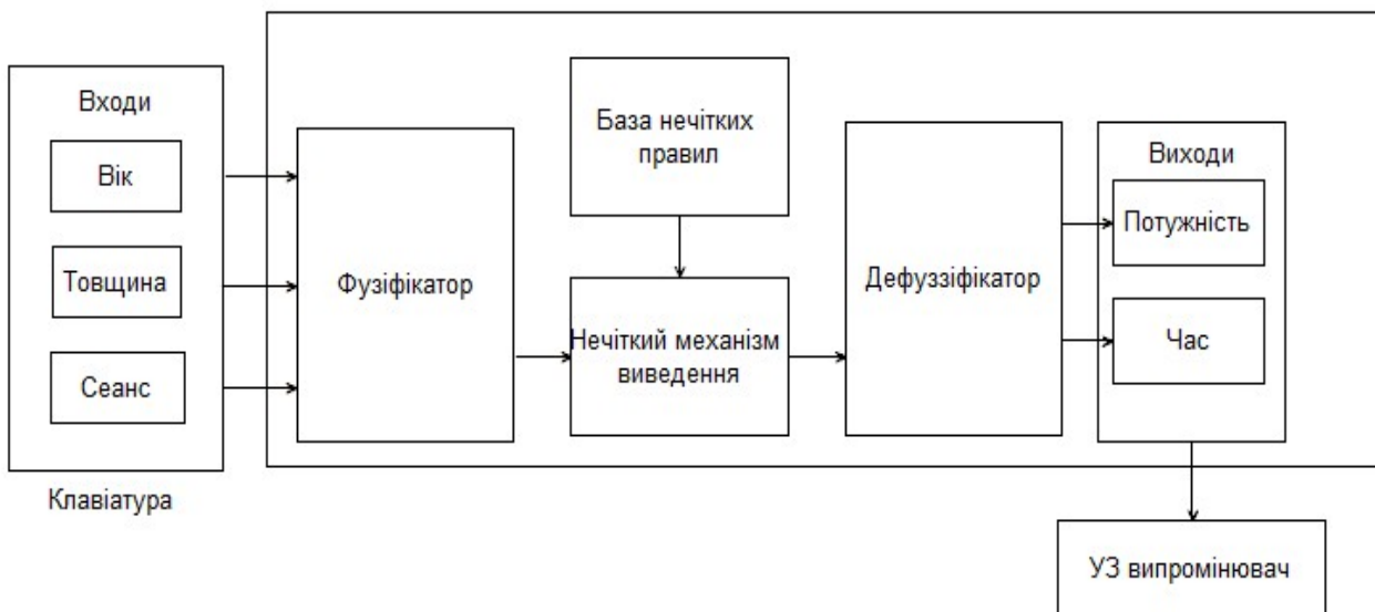
Рис. 4.4. Структура нечіткого логічного підходу для пристрою ультразвукової терапії.
