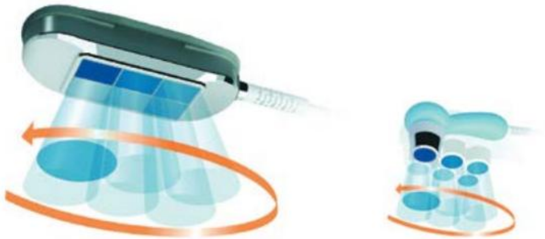
Рис. 2.13. Ілюстрація роботи випромінювача з технологією Hands Free Sono® (зліва), і звичайного випромінювача яким рухає оператор (справа).
