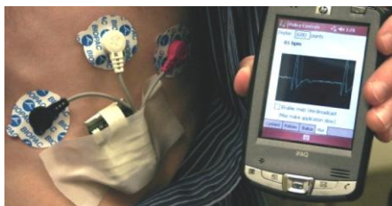
Рисунок 6.9. Бездротова біотелеметрична система (компонент домашньої, індивідуальної телемедицини) 39
