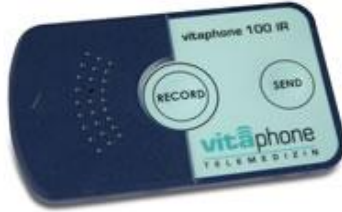
Рисунок 6.2. Побутовий прилад для знімання ЕКГ в 1-му відведенні (для фіксації ЕКГ в 1-му відведенні досить прикласти прилад до грудної клітки в потрібній точці) 33
