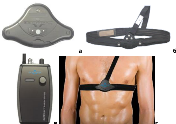
Рисунок 4.1. Універсальна телеметрична система: а - датчик, б- пояс для кріплення додаткових датчиків і передавального пристрою, в - передавальне радіо-пристрій, г - фіксація датчика на тілі 20
