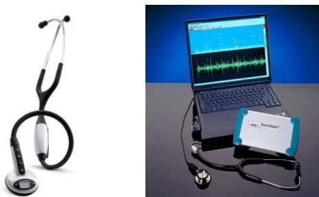
Рисунок 2.4. Цифровий стетоскоп з телемедичними функціями (реальночасова трансляція аускультативної картини й/або фіксація її у вигляді комп'ютерних файлів) 11
