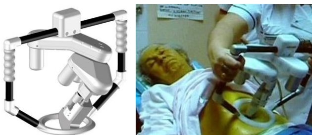
Рисунок 2.7. Роботизований прилад для дистанційного проведення ультразвукових досліджень 14
