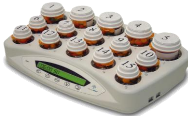
Рисунок 6.3. Прилад для керування (медикаменти розсортовані по контейнерах; відповідно до програми прилад сповіщає пацієнта про необхідність прийому потрібної кількості таблеток з потрібного контейнера) і контролю (якщо пацієнт багаторазово пропустив прийом медикаментів прилад автоматично сповіщає call-центр про можливу недієздатність підопічного) 34
