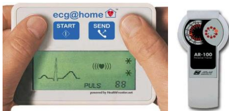
Рисунок 2.2. Параклінічні цифрові електрокардіографи (одноканальні для домашньої телемедицини й медицини катастроф) 10
