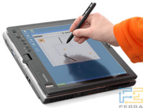
Рисунок 7.14 – Зовнішній вигляд сенсорної панелі для ноутбука [14]
