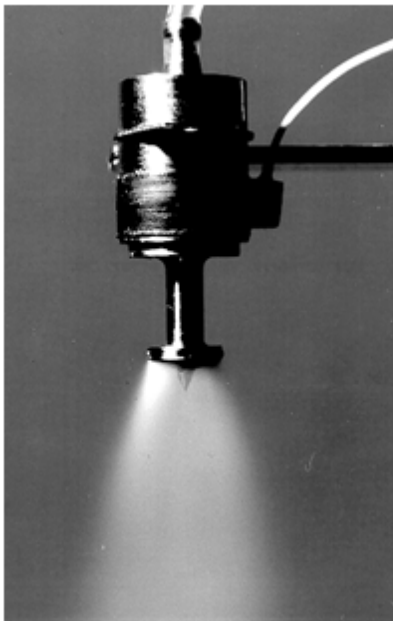
Рисунок 3.17 – Диспергатор з конічною розпилювальною поверхнею та центральним конусом
