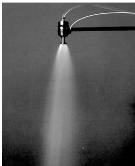
Рисунок 3.16 – Розширений факел з рівномірною щільністю аерозолію
