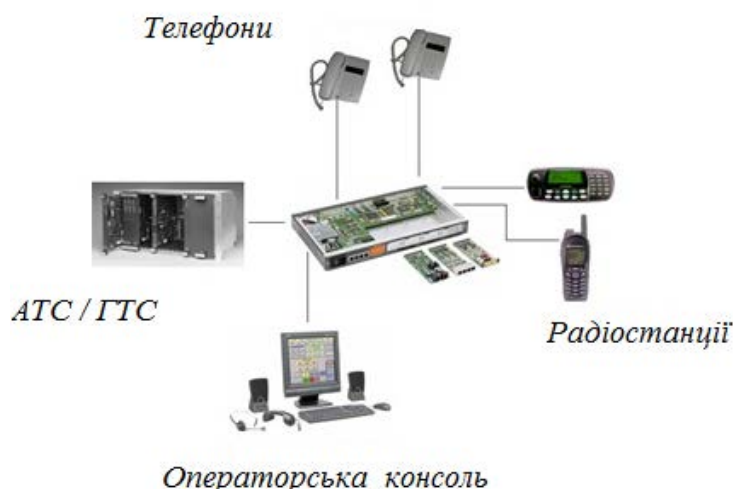
Рисунок 7.20 – Структура розподіленої системи керування серії DCS-5020 компанії ZETRON [53]
