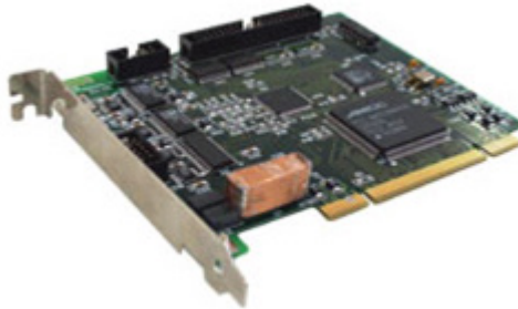
Рисунок 7.1 – Зовнішній вигляд АЦП/ЦАП типу 24/4 на шині PCI компанії «Электронные технологии и метрологические системы» [45]
