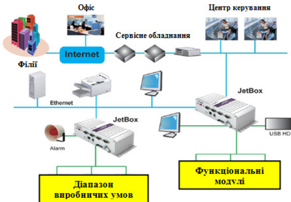
Рисунок 7.21 – Приклад організації мережі Ethernet на базі комунікаційних маршрутизаторів JetBox 9300 компанії PLC Systems [55]
