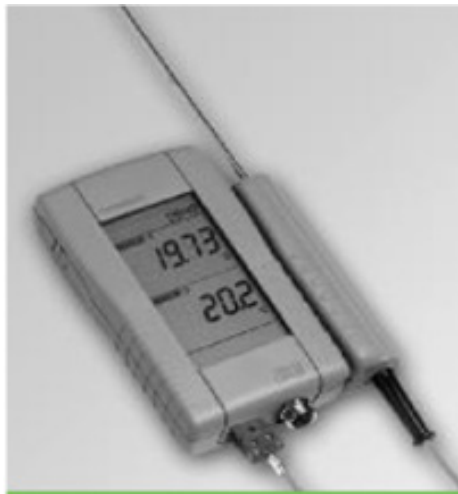
Рисунок 4.15 – Зовнішній вигляд ручного сенсора температури моделі THERMOPORT 20 [4]
