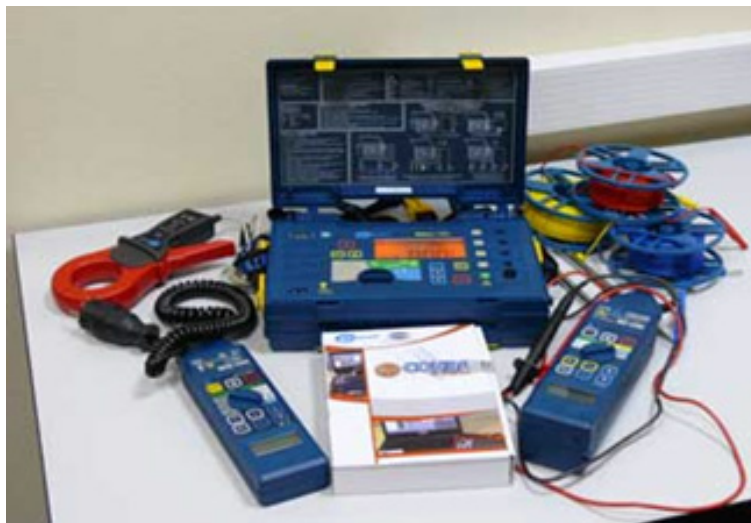
Рисунок 7.23 – Комплект діагностичного та ремонтного обладнання у складі мобільної лабораторії компанії «АРМЕКС» [57]
