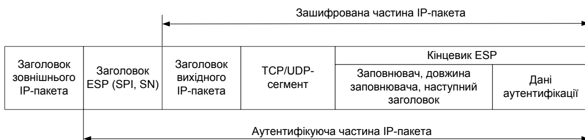
Рисунок 8.6 – IP-пакет, оброблений ESP у тунельному режимі
