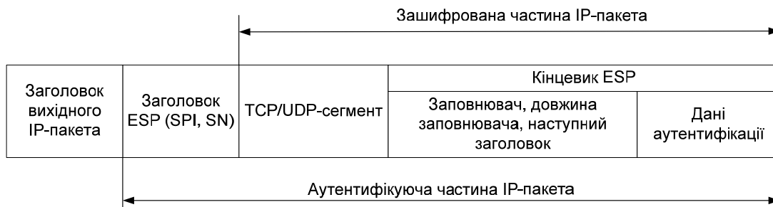
Рисунок 8.5 – IP-пакет, оброблений ESP у транспортному режимі
