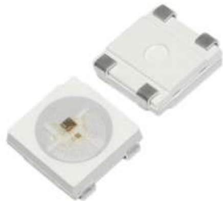
Рисунок 2.21 – Вигляд знизу та зверху світлодіода WS2812B
