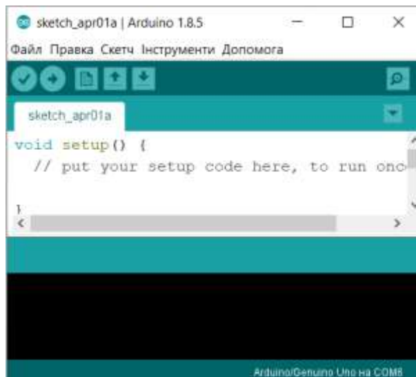
Рисунок 2.13 – Визначення порта підключення плати Arduino Uno
