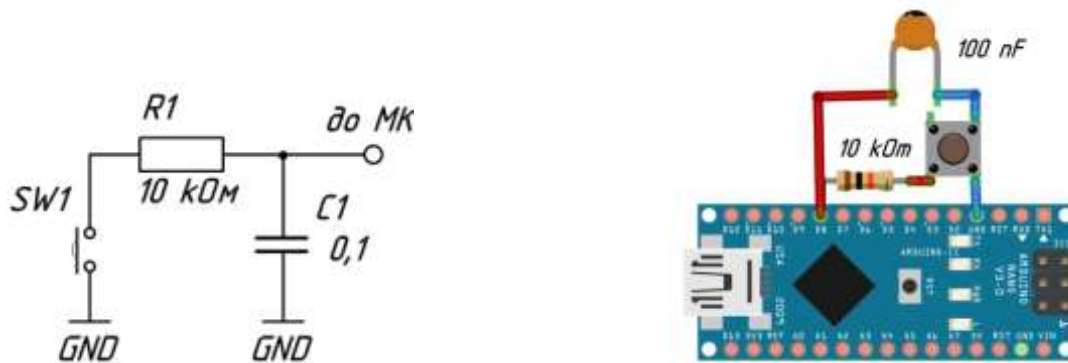
Рисунок 2.5 – Апаратна реалізація RC-кола на тактовій кнопці для антибрязкоту
