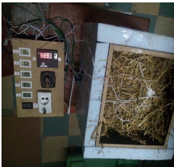
Рисунок 2.10 – Світлина реалізації блока автоматичної реєстрації температури: БАРТ(зліва) та дослідний зразок спресованої соломи, що розміщений в корпусі установки (справа)
