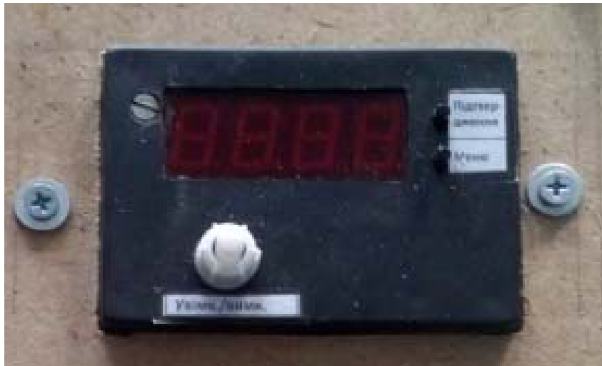
Рисунок 2.13 – Світлина багатоканального вимірювача температури Т-056МК
