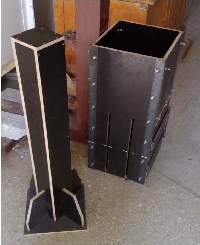
Рисунок 2.22 – Світлина установки для пресування солом'яних тюків, загальний вигляд
