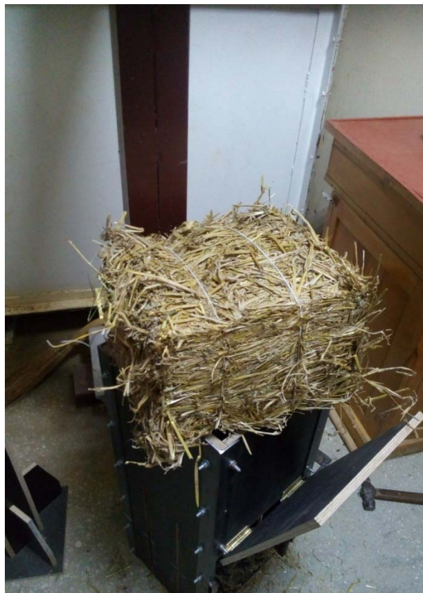
Рисунок 2.24 – Світлина експериментального солом'яного блока щільністю 160 \text{ кг/м}^3
