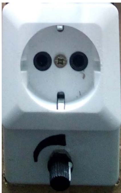
Рисунок 2.17 – Світлина димера для регулювання навантаження ТЕНа
