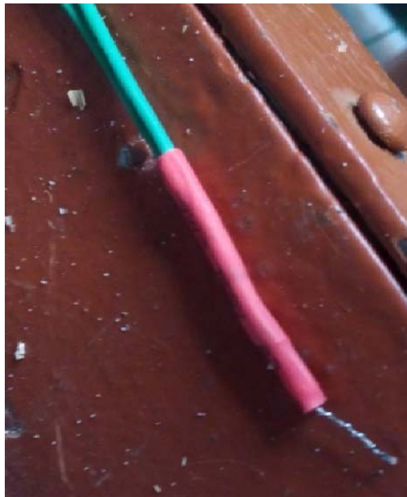
Рисунок 2.18 – Світлина хромель-копелевої термопару для вимірювання температури (крупним планом)
