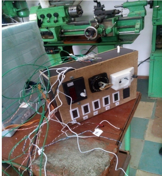
Рисунок 2.12 – Світлина загального вигляду блока БАРТ з комунікаціями до термопар
