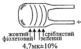
Рисунок 2.5 – Маркування танталових конденсаторів
