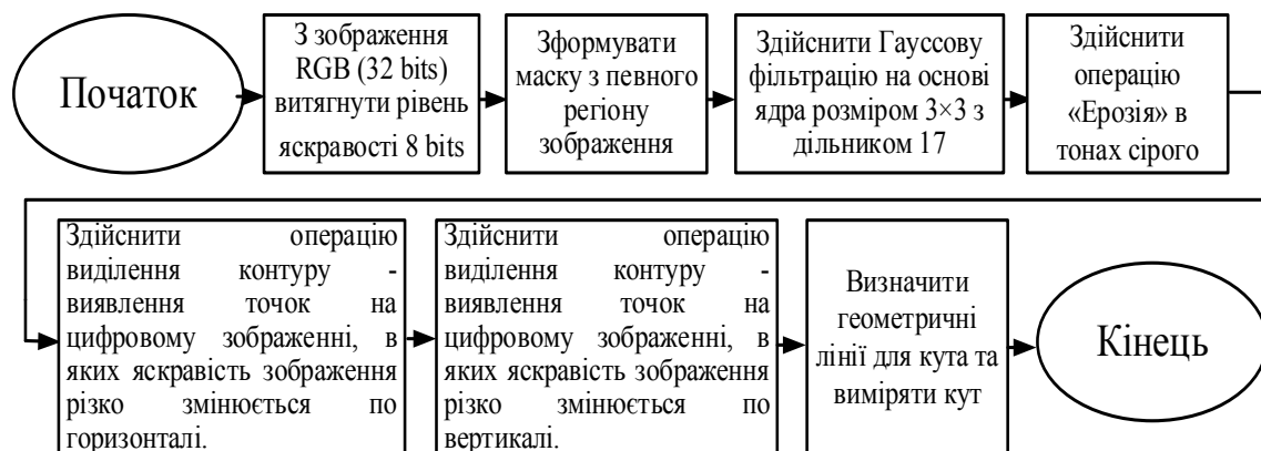
Рисунок 3.4 – Алгоритм комп'ютерної дослідження 2d ультразвукових зображень дисплазії кульшового суглоба з використанням інструмента виділення контуру «Find Straight Edge»
