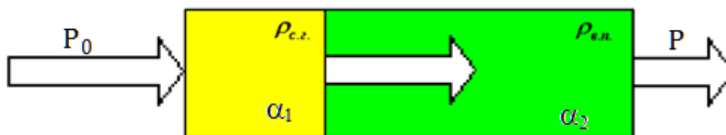
Рисунок 2.4 – Модель перенесення випромінювання в середовищі вологого газу
