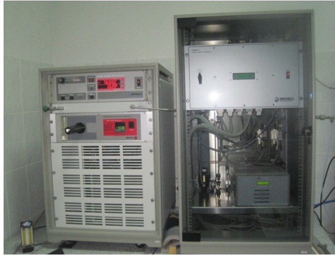
Рисунок 4.4 – Зовнішній вигляд стаціонарної калібрувальної системи Michell Dew Point Calibration System
