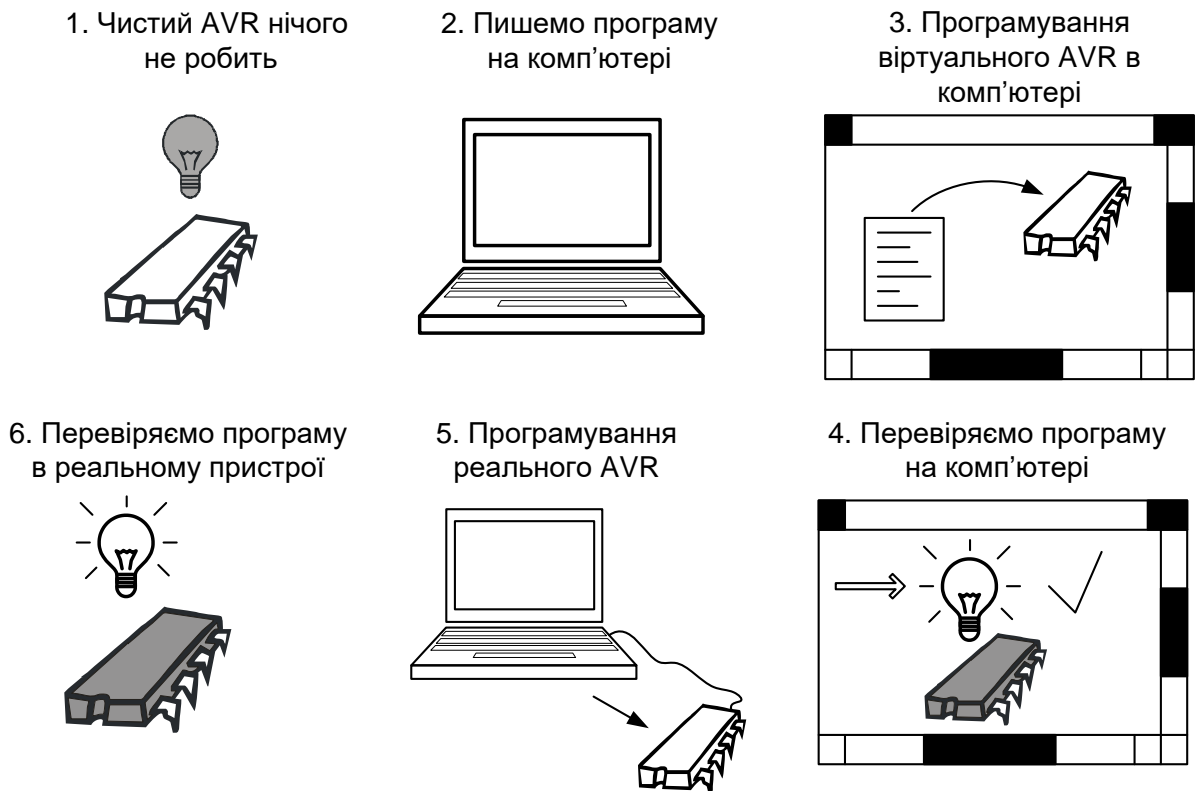
Рис.1.11. Етапи розробки програмного забезпечення мікроконтролерів AVR
