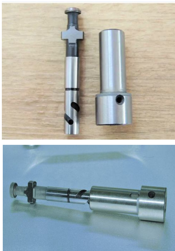
Рисунок 1.8 — Фото плунжерної пари та її схема з розмірним ланцюгом
