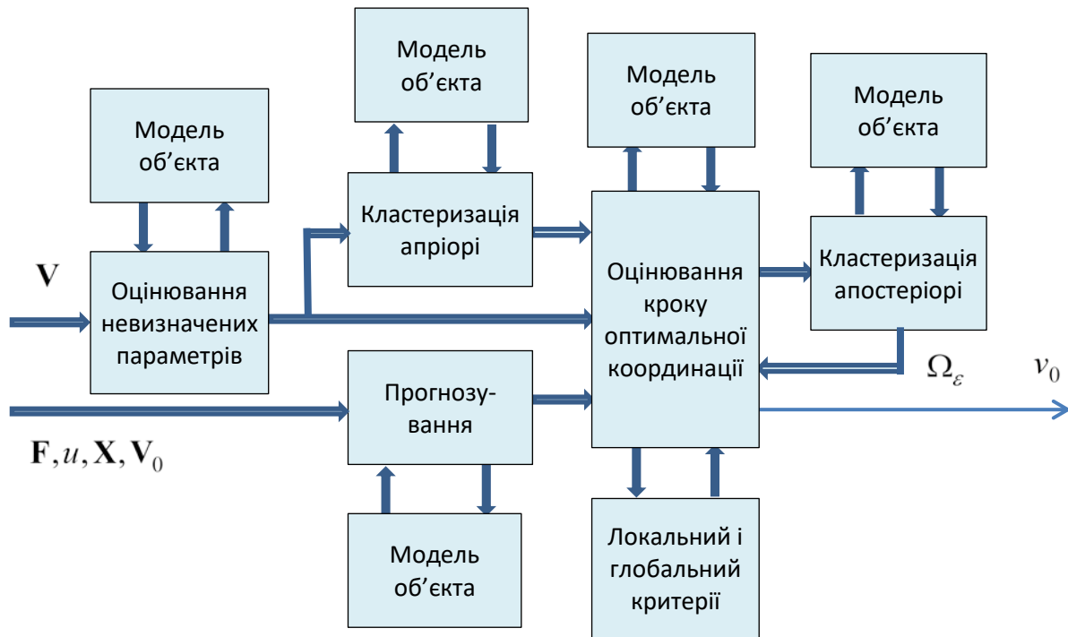
Рисунок 4.4 – Схема взаємодії модулів координатора
