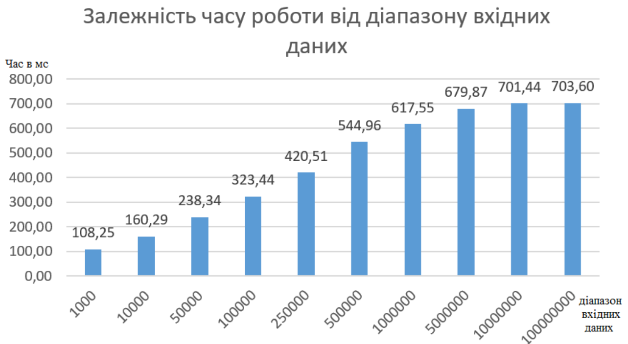
Рисунок 1 – Графік залежності часу роботи алгоритму сортування двійковим деревом від діапазону вхідних даних
