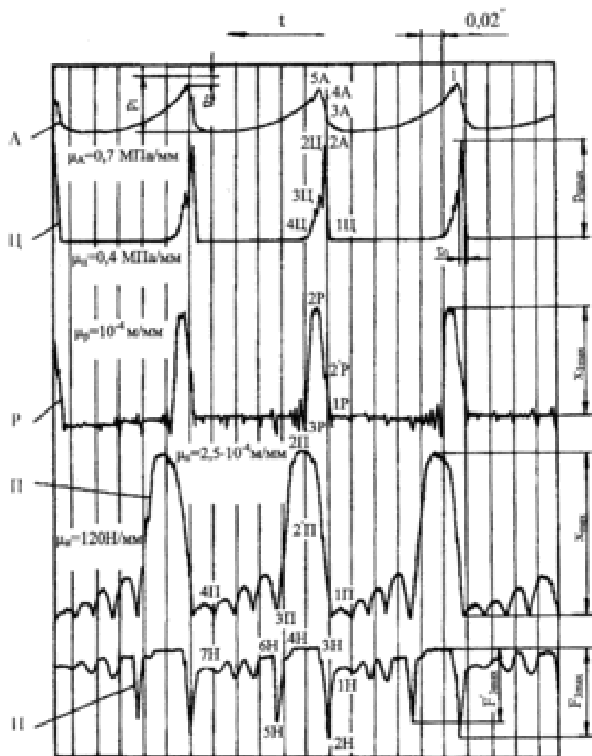
Рисунок 7.11 – Осцилограми робочого режиму ІВПМ з віброзбуджувачем „на вході” ( Q_{н1} = 0,25 \cdot 10^{-3} \text{ м}^3/\text{с} , m_2 = 32 \text{ кг} )
