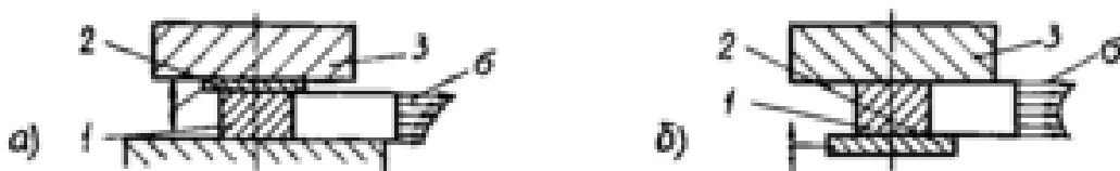
Рисунок 5.1 – Принципові інерційні схеми пресування з верхнім (а) і нижнім (б) розташуванням робочої ланки
