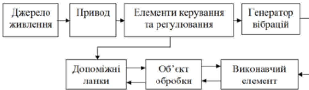
Рисунок 1.2 – Структурна схема вібраційних та віброударних машин
