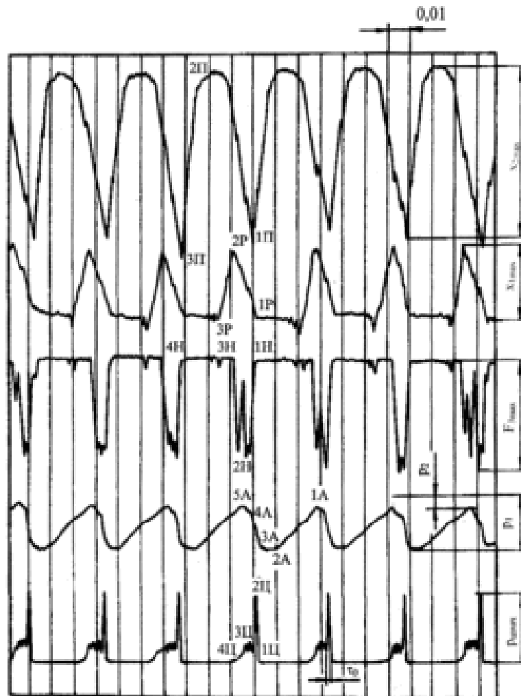
Рисунок 7.12 – Осцилограми робочого режиму ІВПМ з вібробуджувачем „на вході” ( Q_{H1} = 10^{-3} \text{ м}^3/\text{с} , m_2 = 127 \text{ кг} )
