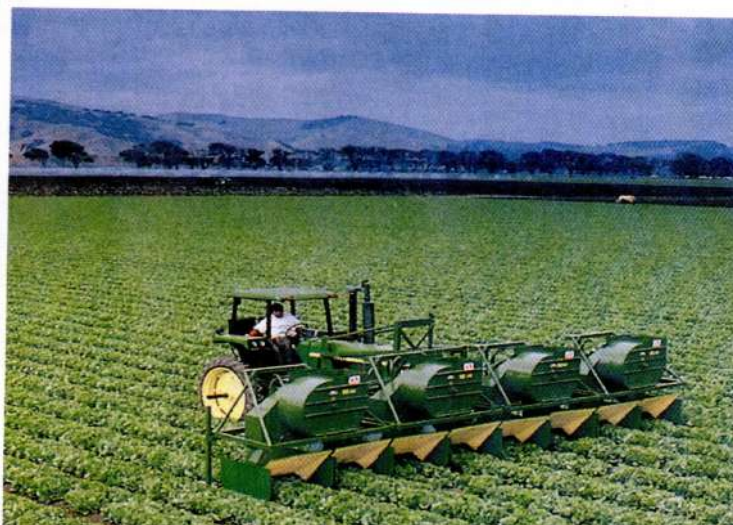
Рисунок 4 – Восьмирядна машина „Селед Вак” на полях картоплі у Каліфорнії (США)
