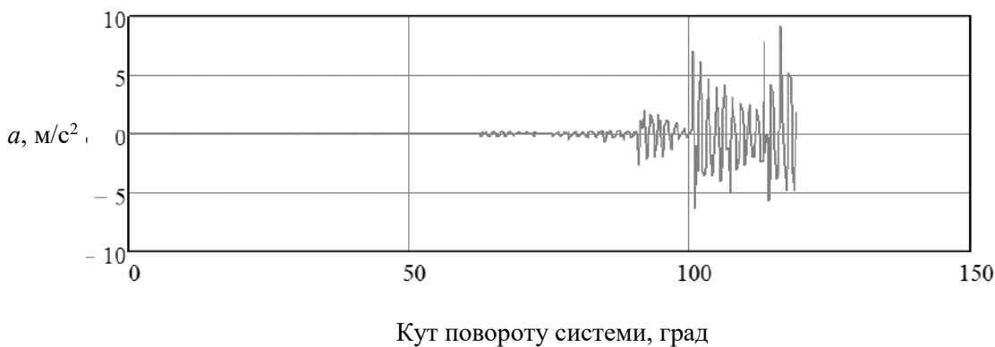
Рисунок 8 – Характер прискорень кузова ПВ при перекиданні
