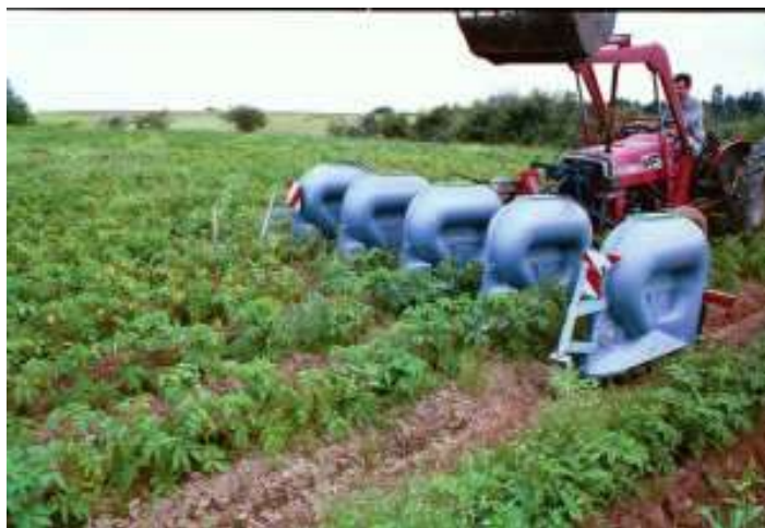
Рисунок 5 – Пневматична машина на збиранні шкідників на полях ферм в Новій Шотландії
