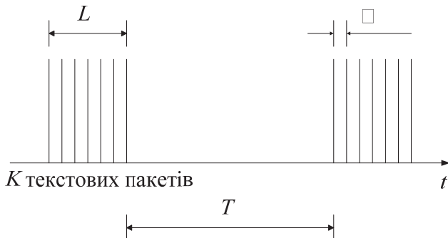
Рис.5.2. Ілюстрація структури тестового потоку пакетів для вимірювання величини параметра RTT
