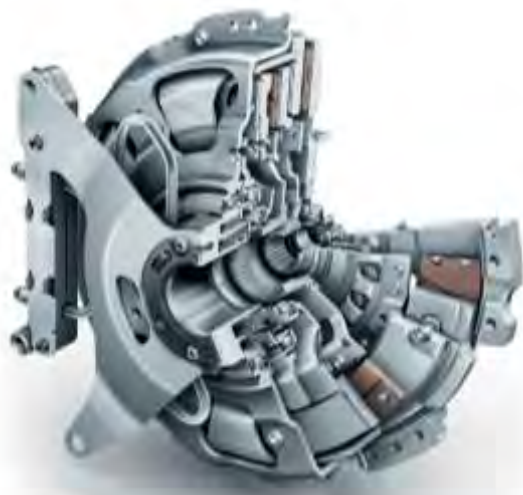
Рисунок 1 – Загальний вигляд подвійного (здвоєного) зчеплення сухого типу
