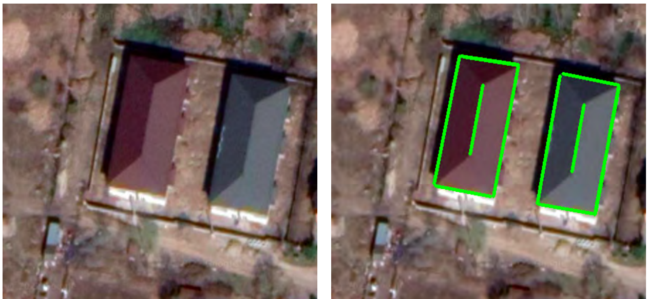
Рисунок 5 - Результат роботи алгоритму для знаходження контурів країв та гребіння даху
