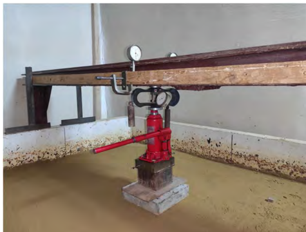
Рис. 4 – Модель випробування плити ростверку
