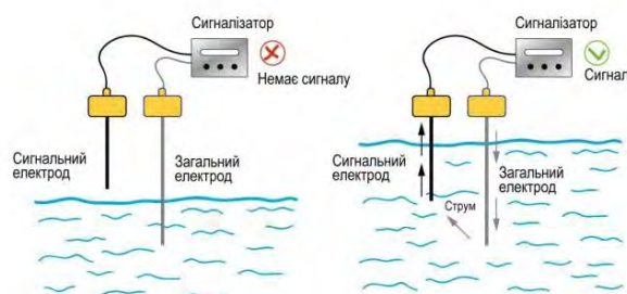
Рис. 1. Принцип роботи кондуктометричних датчиків
