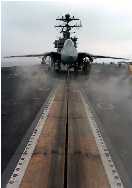
Рис. 2. Парова катапульта на авіаносці
