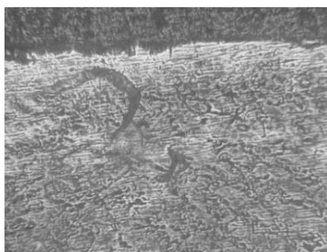
Рис. 1 – Мікроструктури поверхневого шару заготовки
