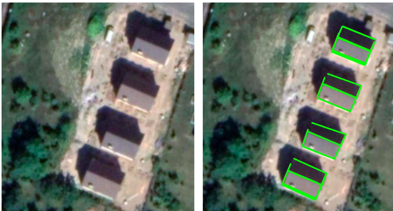
Рисунок 6 - Результат роботи алгоритму для знаходження контурів країв та гребіння даху
