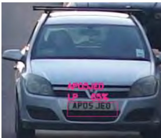
Рис. 3 – Приклад розпізнавання номерного знаку
