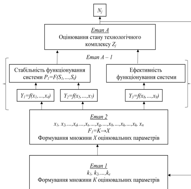
Рис. 2. Алгоритм оцінки ефективності процесу формування дорожнього полотна
