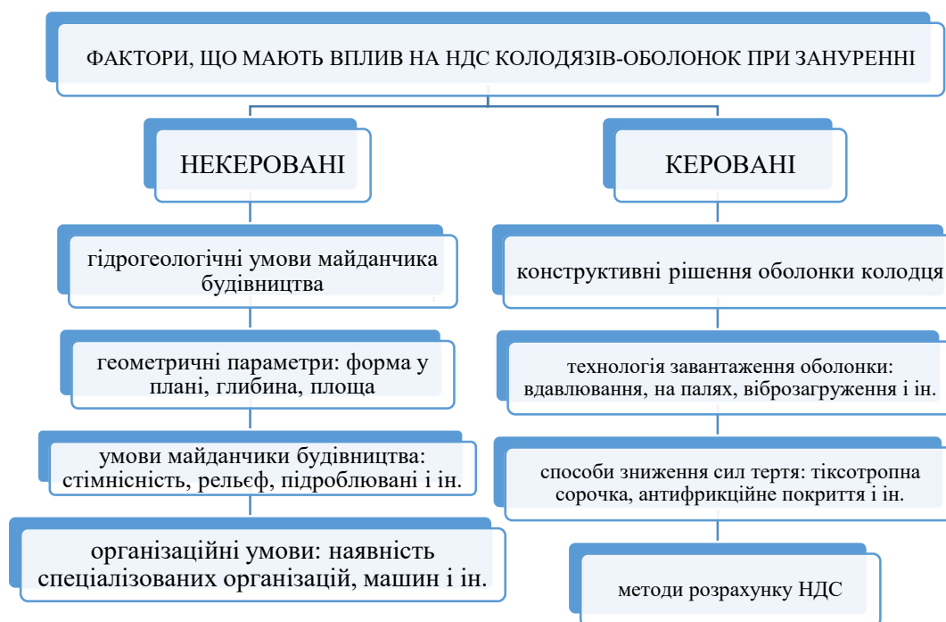
Рис. 1. Класифікація факторів, що впливають на напружено-деформований стан (НДС) колодязів-оболонок
