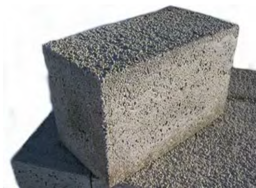
Рис. 6. Блоки із корозійностійкого бетону
