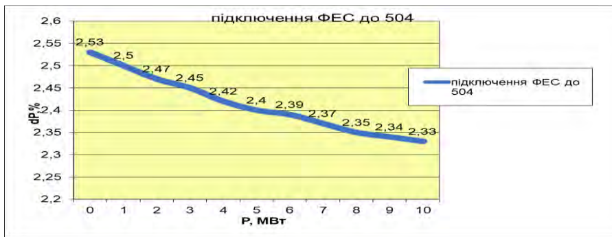
Рисунок 3 – Втрати електроенергії у мережі при різних встановлених потужностях ФЕС
