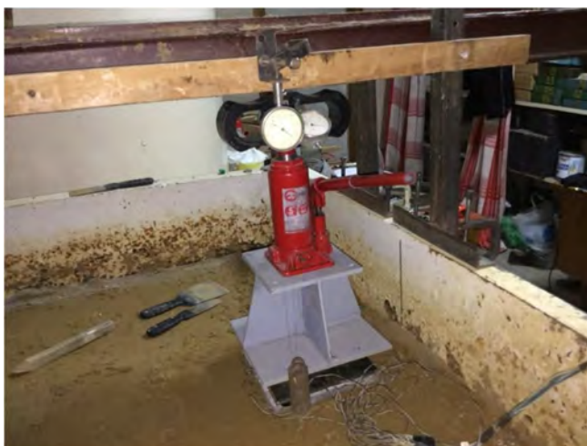
Рис. 3 – Модель пальового фундаменту перед випробуванням
