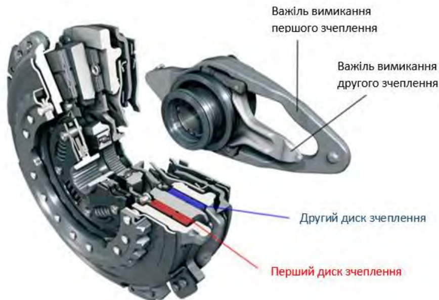
Рисунок 3 – Сухе здвоєне зчеплення
