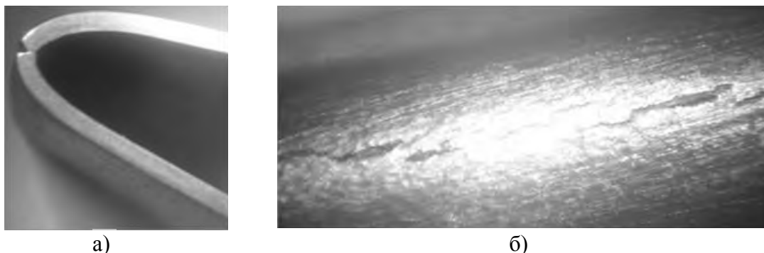
Рис. 2. Фотографії дефектів, отриманих при формуванні гофрів гнуттям: а) – вид макротріщини з торця листа; б) – зародження і розвиток тріщин вздовж гофра (матеріал – сталь У8А, товщина – 1,2 мм)
