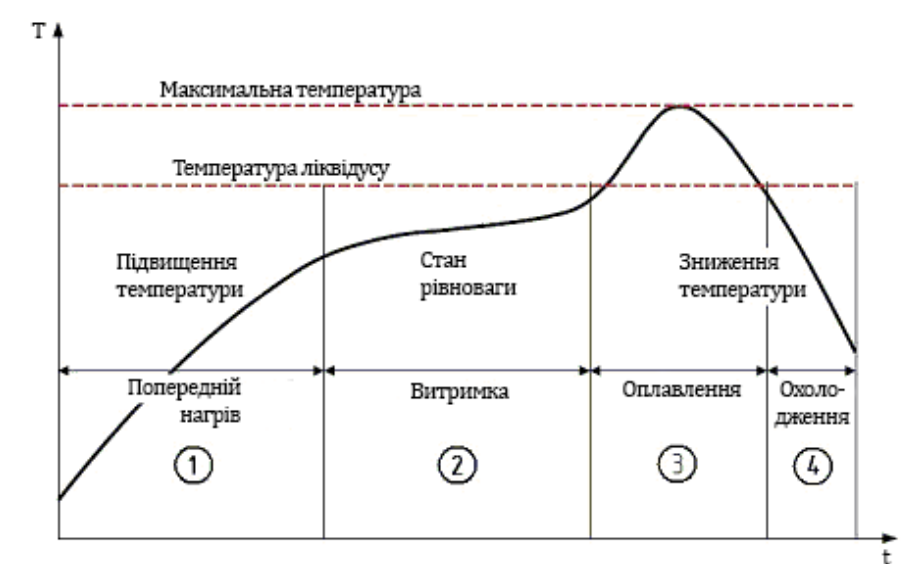
Рис. 1. Типовий температурний профіль пайки
