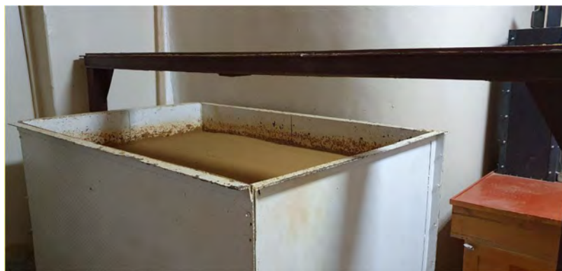
Рис. 2 - Лоток з ґрунтовою основою під фундамент
