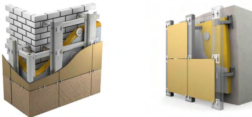
Рисунок 1 – Влаштування вентиляованого фасаду
