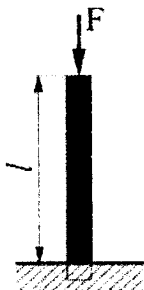
Рисунок 13.9 – Схема закріплення та навантаження дерев'яної стійки
