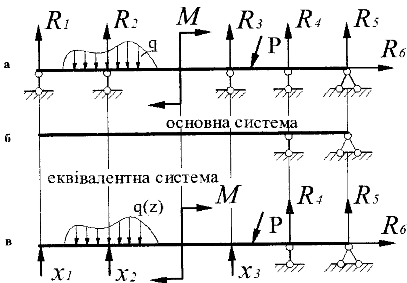
Рисунок 8.11 – До розкриття гіперстатичності багатопрольотної нерозривної балки
