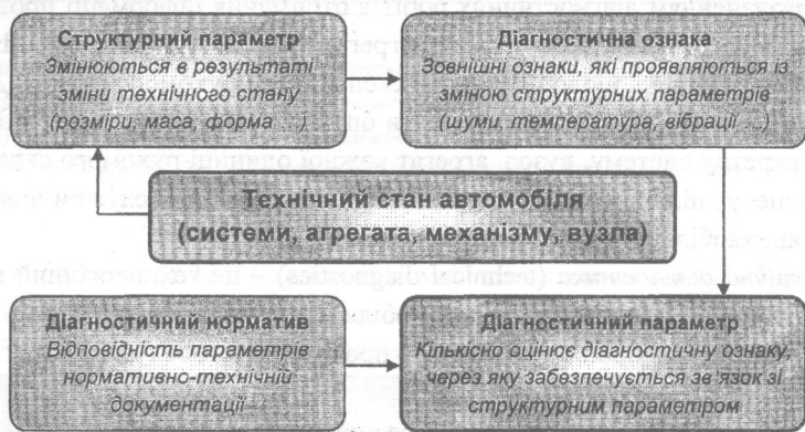
Рисунок 1.19 – Взаємозв'язок діагностичних параметрів з технічним станом автомобіля
