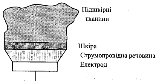
Рисунок 5.2 – Електричні властивості контакту електрод-шкіра
