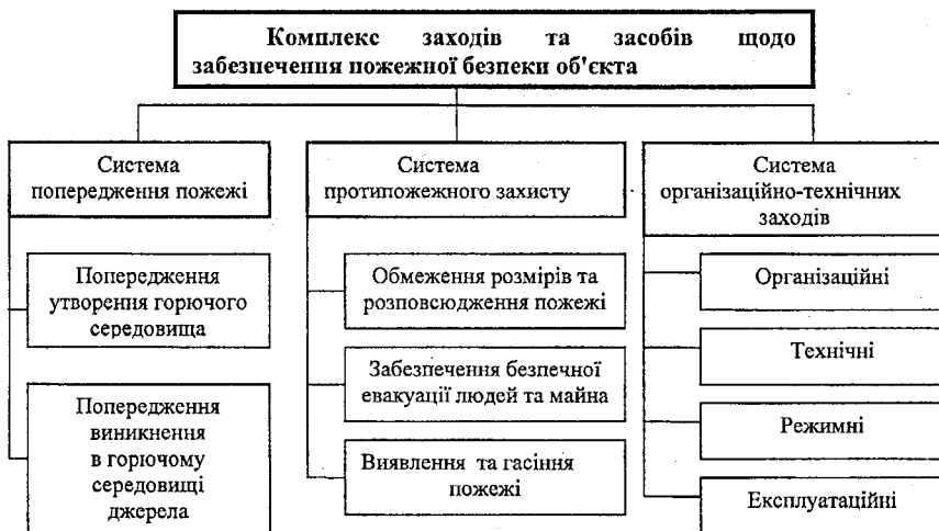
Рисунок 2 – Загальна схема комплексу заходів та засобів щодо забезпечення пожежної безпеки об'єкта
