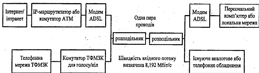
Рисунок 3.5 – Архітектура ADSL
