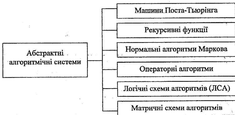
Рис. 6.2. Клас абстрактних алгоритмічних систем (алгоритмічні моделі)
