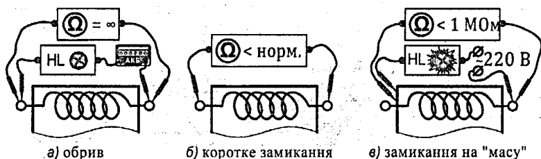
Рисунок 1.18 – Перевірка технічного стану обмоток і котушок
