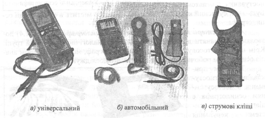
Рисунок 1.2 – Комбіновані мультиметри та автотестери
