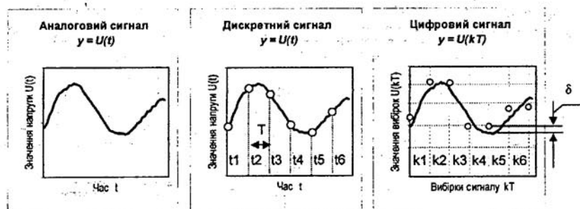
Рисунок 1.11 – Перетворення аналогового сигналу в цифровий
