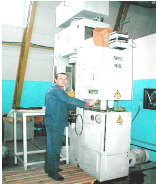
Рисунок 5.8 - Прес для виробництва гумових ущільнювачів вимикачів
