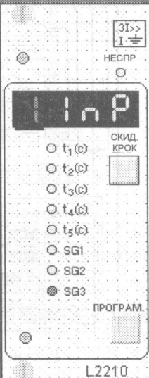
Рисунок 40 – Стан перемикачів на вході SPAC 801
