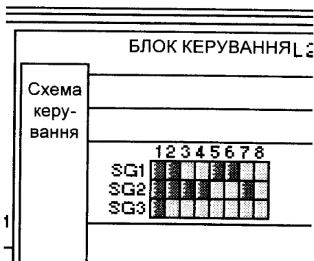
Рисунок 57 – Вміст розрядів регістрів після встановлення ключа SG1/8 у положення «0»
