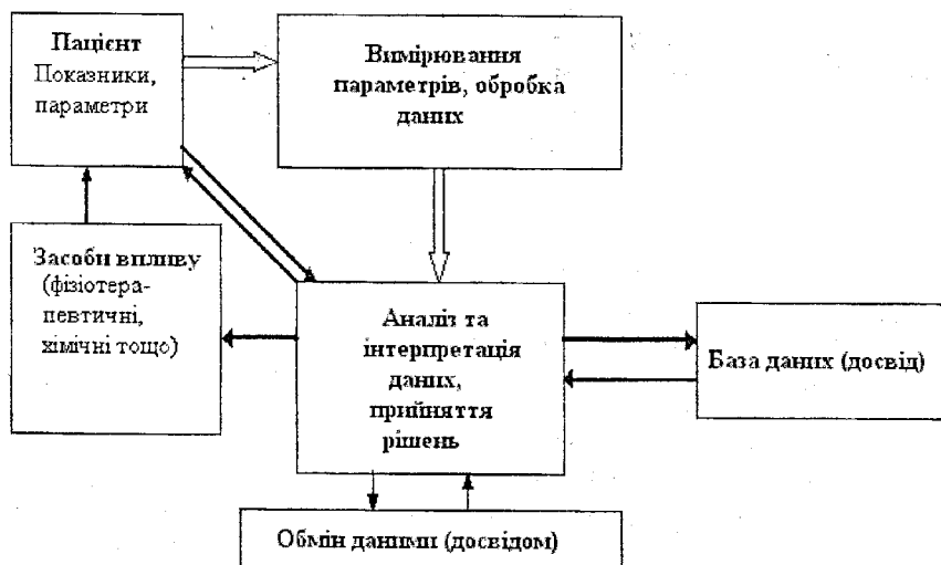
Рисунок 3.1 – Узагальнена структурна схема біотехнічної системи медичного призначення
