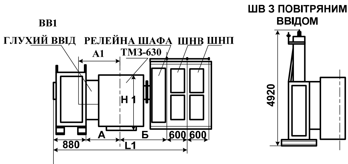
Рисунок 7.13 – Конструктивне виконання КТП зовнішнього встановлення
