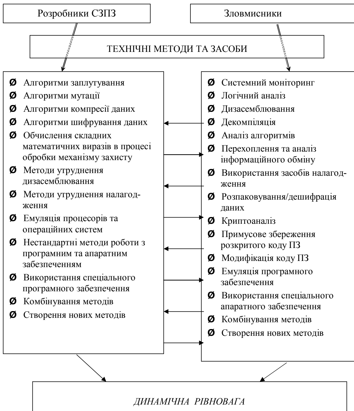
Рисунок 1.1 – Схема протистояння технічних методів і засобів захисту ПЗ
