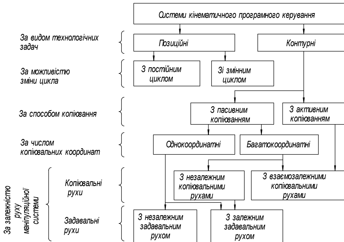
Рисунок 3 – Класифікація систем кінематичного програмного керування координатами ланок маніпуляційних систем устаткування для дугового зварювання і наплавлення
