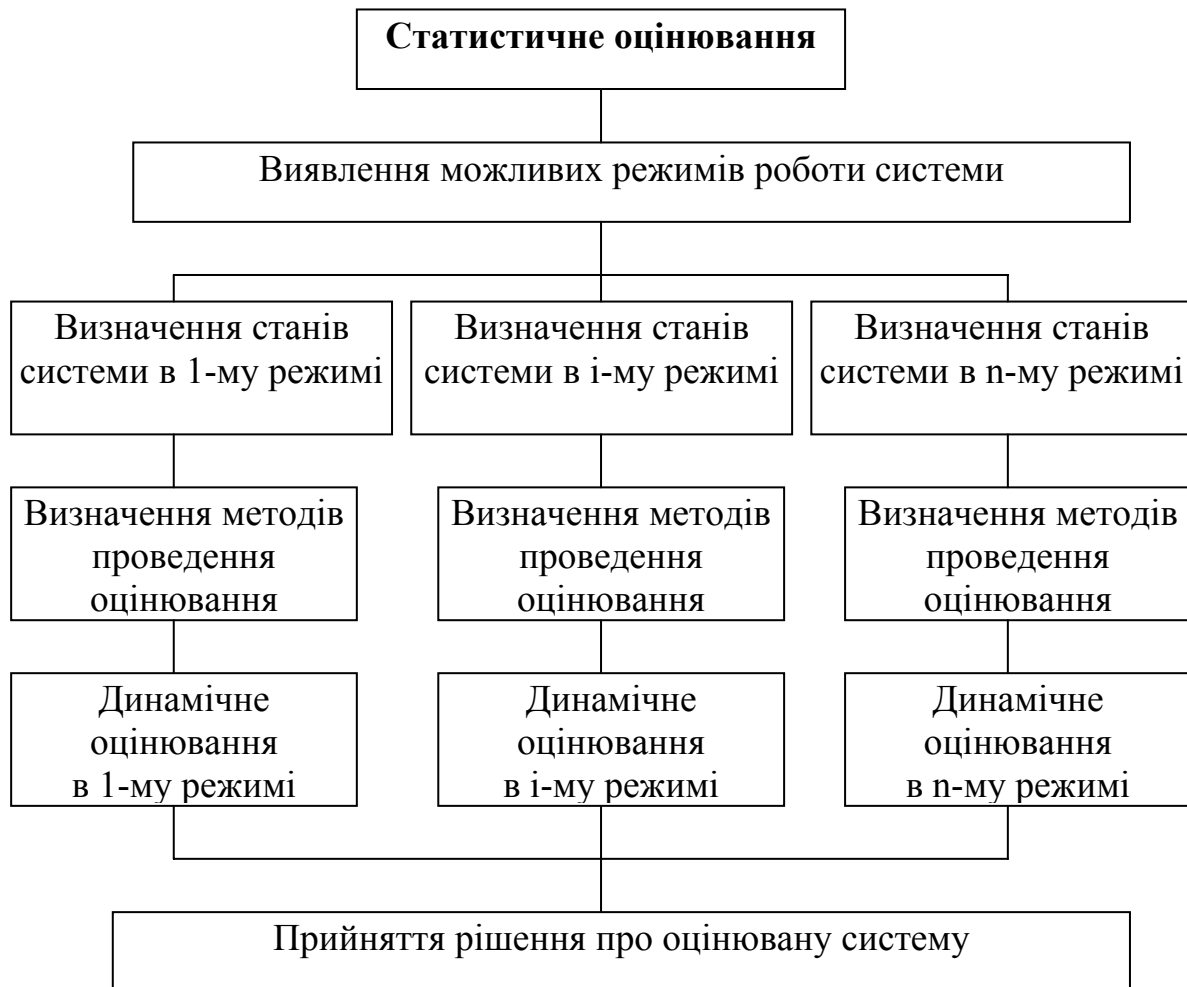
Рис. 17. Схема проведення інженерно-психологічного оцінювання при пошуку і ліквідації несправностей, при контролі функціонування; - за характером проведення оцінювання: статичне та динамічне; - за результатом оцінювання: комбіноване, якісне, кількісне. ІПО повинно проводитися для кожного з режимів системи “люди
