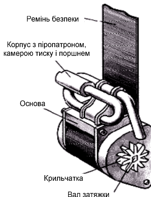
Рисунок 1.4 – Блок керування з пороговими пристроями і піропатронами
