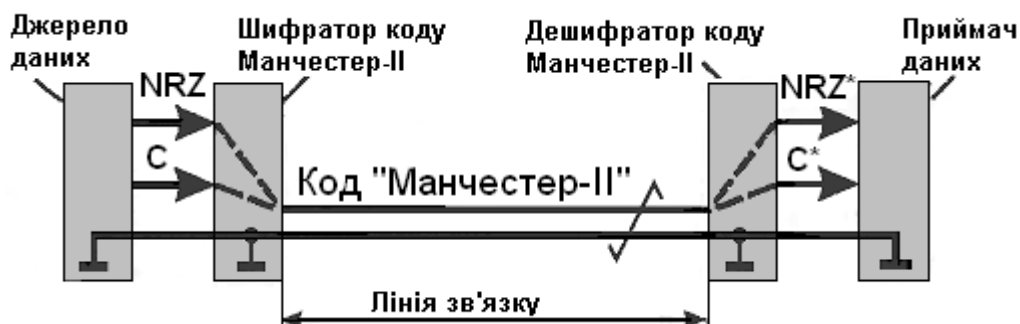
Рисунок 7.10 – Спрощений приклад побудови каналу зв'язку для передачі даних у код "Манчестер-II"
