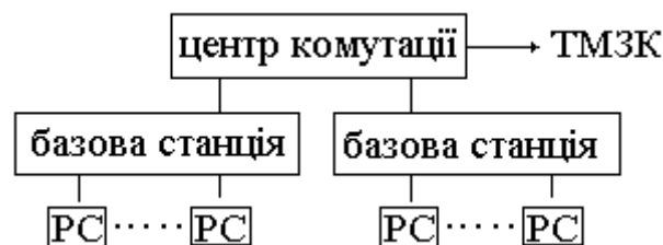
Рисунок 8.2 – Спрощена функціональна схема системи стільникового зв'язку
