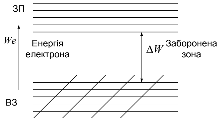
Рисунок 2.2 – Енергетична діаграма напівпровідника
