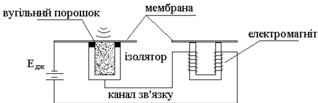
Рисунок 6.2 – Спрощена схема системи телефонного зв'язку
