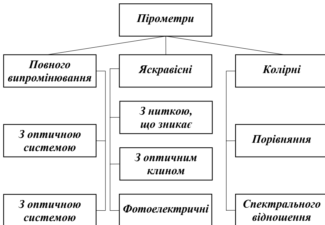
Рисунок Л1.10 - Класифікація пірометрів дозволяють вимірювати температуру з похибкою \pm 0,5^\circ\text{C} .
