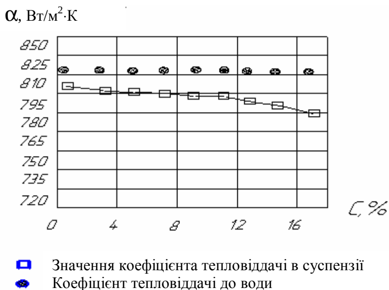
Рисунок 2.5 – Залежність коефіцієнта тепловіддачі від концентрації сухої речовини
